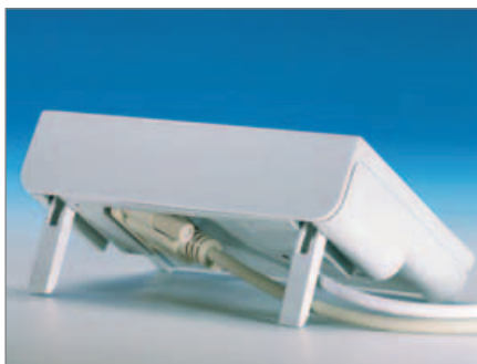
Interface RS 232/484 optocouplée intégrée en série
